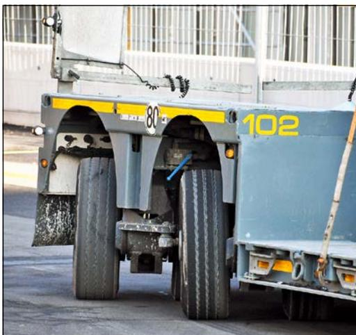
**Les essieux directionnels de la semi-remorque facilitent grandement les manœuvres.**
