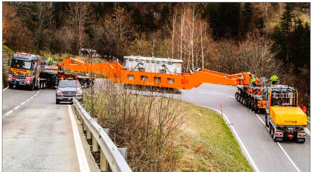
einfach. So musste denn auch eine Spezialfirma beauftragt werden. Es gab mehrere Knackpunkte, wie Bewilligungen, Brücken, enge Kurvenradien, Verkehr und so weiter. Für die Massabrücke in Bitsch musste der statische Nachweis erbracht werden, dass diese den Belastungen standhält. Aufgrund des zu engen Kurvenradius musste in Deisch, kurz nach dem Kehrtunnelausgang der MGBahn, sogar seitlich der Hauptstrasse die bergseitige Böschung abgetragen werden. Ansonsten wäre kein Durchkommen möglich gewesen.
