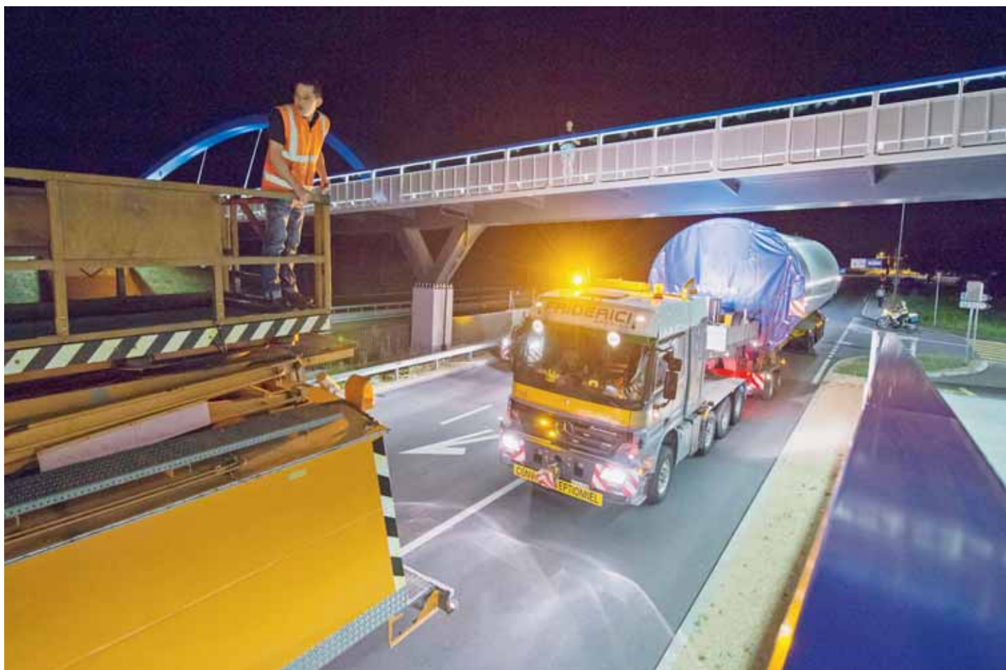
Premier passage délicat en partant de Marin, la passerelle sur les Champs-Montants. Le 2e convoi, 5m10 de hauteur, le passe tout juste.
