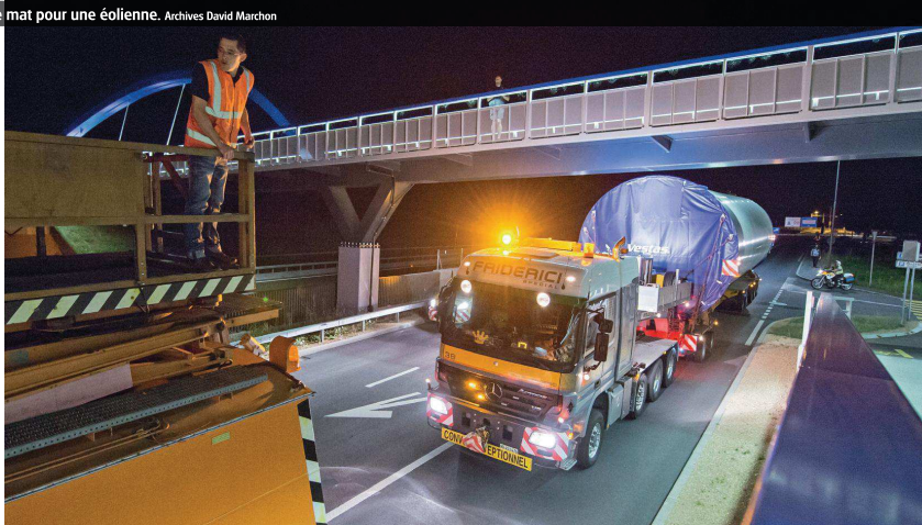
Transport de sections de mat pour une éolienne. Archives David Marchon
